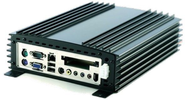
Figure 13:A VoomPC-2 miniITX computer.
